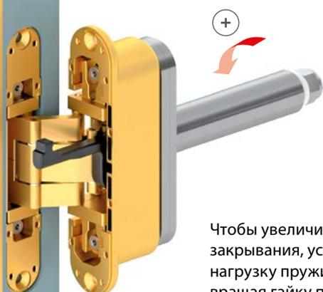
Чтобы увеличить силу закрывания, усильте нагрузку пружины, вращая гайку против часовой стрелки гаечным ключом 17 мм.
