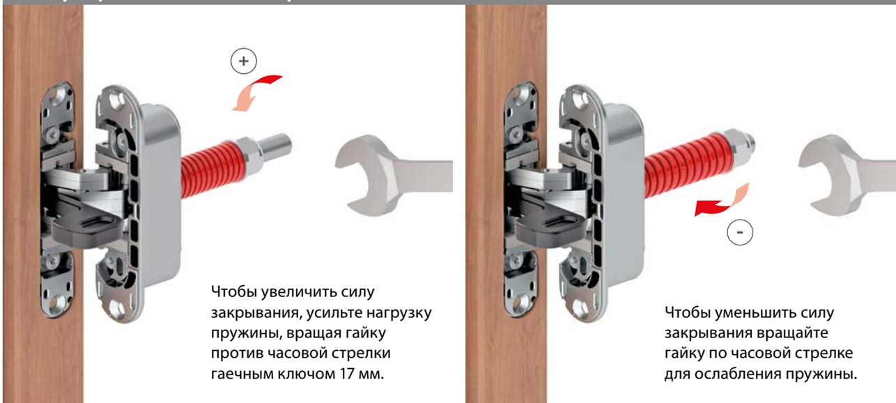
Чтобы увеличить силу закрывания, усильте нагрузку пружины, вращая гайку против часовой стрелки гаечным ключом 17 мм.
