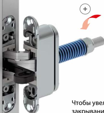
Чтобы увеличить силу закрывания, усильте нагрузку пружины, вращая гайку против часовой стрелки гаечным ключом 17 мм.
